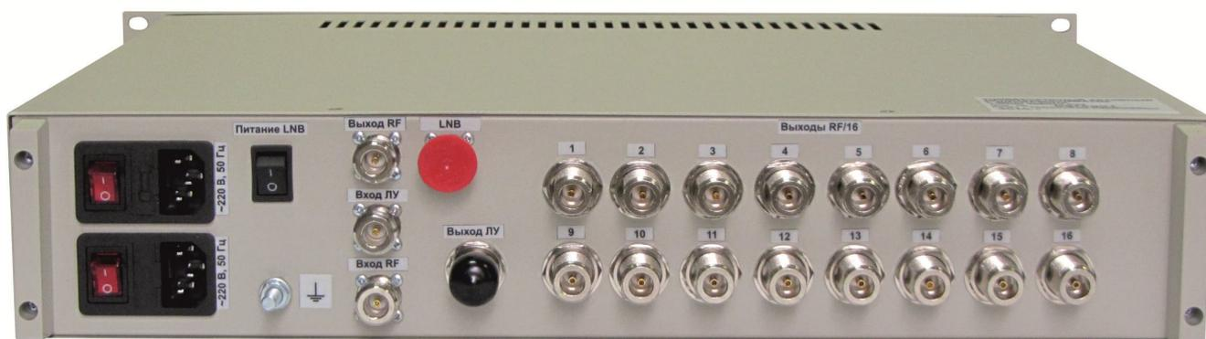
Рисунок 1.1 б – Внешний вид УАДС L со стороны задней панели
